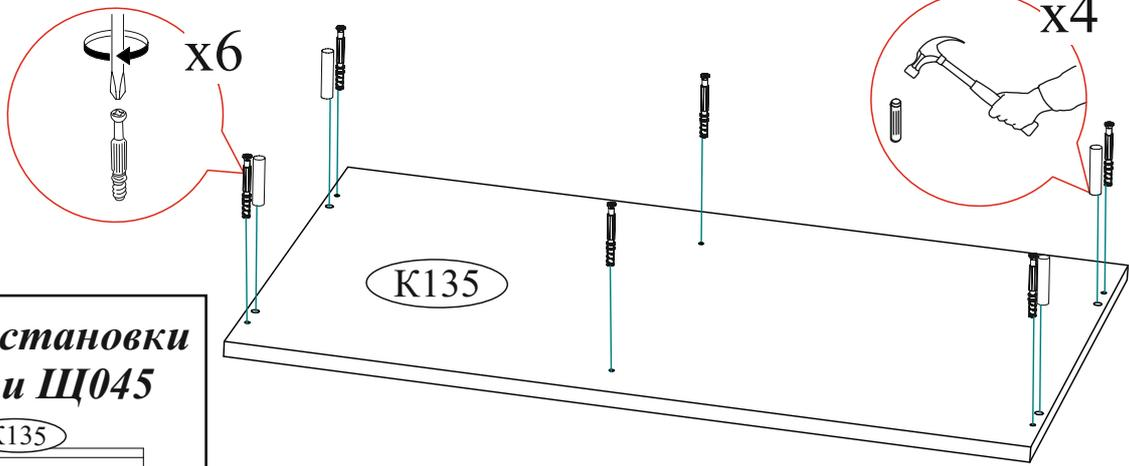
**Схема установки детали Щ045**
