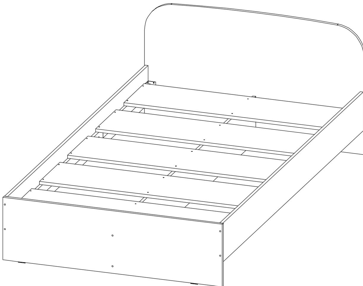
**Кровать должна использоваться по назначению. Прыжки, падение, хождение по кровати не допускается - приведет к поломке крышек (поз. 5). Кровать эксплуатировать только с пружинным матрасом высотой 150-200 мм. Нагрузка на спальное место до 200 кг.**
