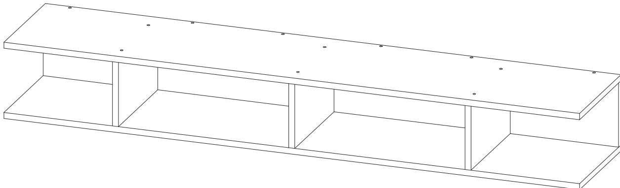
Нагрузка - не более 5кг при равномерно распределённых статичных нагрузках.
