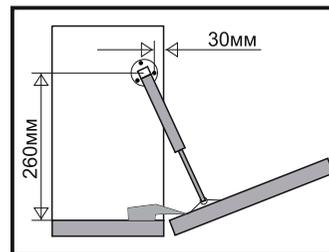
Схема установки межсекционной стяжки
